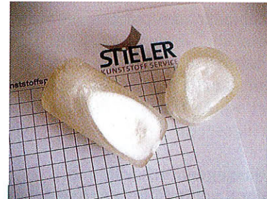
Abb. 3a: Dieser physikalisch geschäumte transparente Weinkorken aus TPE wird von Stieler als laufende Applikation auf der Fakuma gezeigt. Der Korken wird mit extrem kurzem Zyklus mit diversen kombinierten Sonderverfahren hergestellt und danach durch ein neuartiges Laserbeschriftungssystem bearbeitet.
