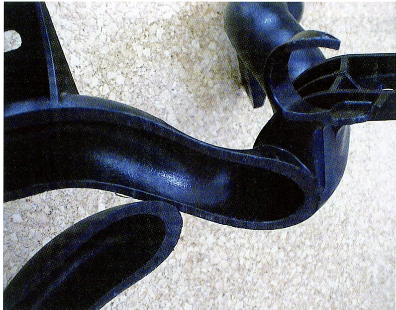
Eine komplex geformtes Kühlwasserrohr aus dem Automobilbau, hergestellt in Wasser-Injektionstechnik (WIT) Foto: Stieler
