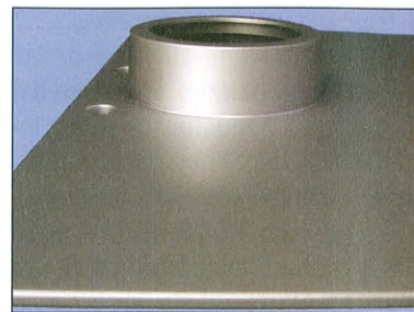
Das EGM-Verfahren erzielt hochwertige Oberflächen mit geringen Eigenspannungen
