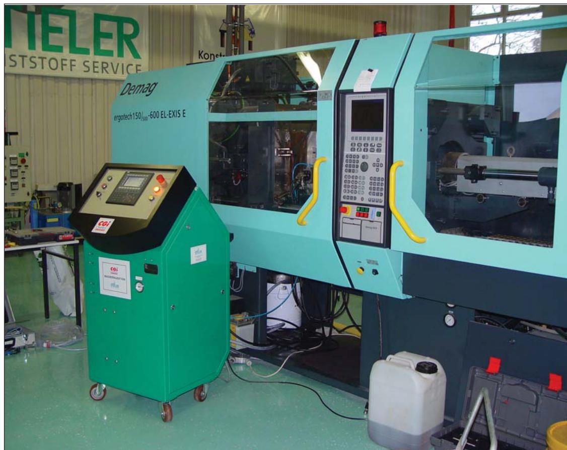
Für die hydraulische Steuerung der speziellen Injektortechnik sorgt ein kompaktes Wasserinjektionsgerät von CGI
