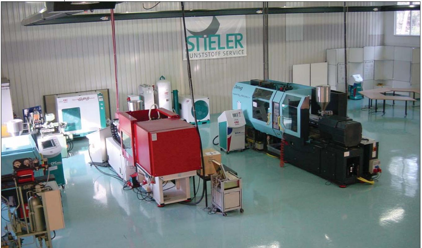
*Blick in das Spritzgieß-Technikum bei Stieler Kunststoff Service GmbH mit Spritzgießmaschinen von 250 bis 1.500 kN Schließkraft*
