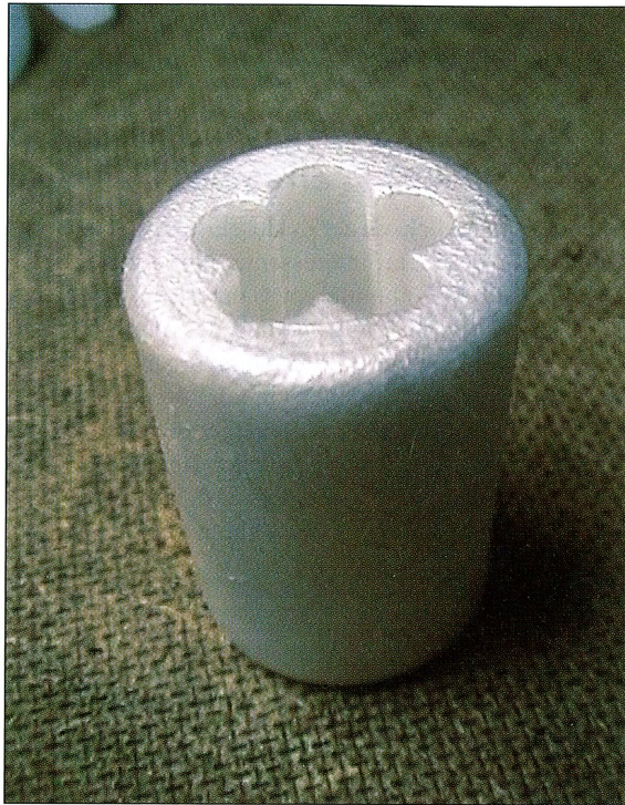
Mit dem SmartFoam-Verfahren hergestellter Schwimmer
